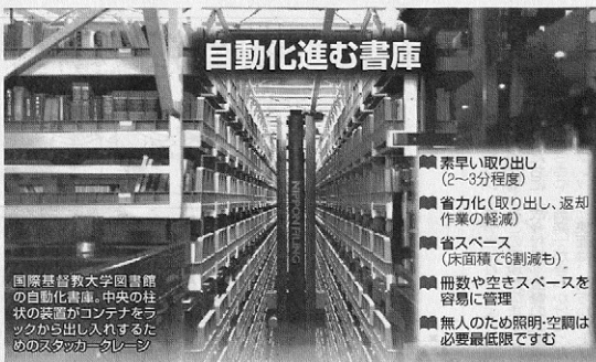
国際基督教大学図書館の自動化書庫。中央の柱状の装置がコンテナをラックから出し入れするためのスタック・クレーン
